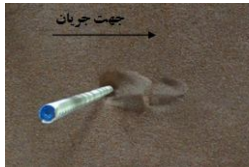
شکل ۶- توسعه حفره آبشستگی پیرامون پایه ۱۰ mm بر حسب سانتی‌متر ( V/V_c = 0.95 ).
