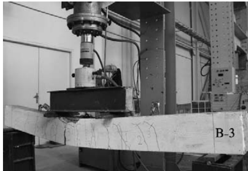
شکل ۱- دستگاه‌های آزمایش استاتیکی
