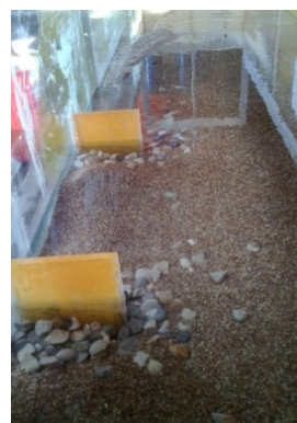
شکل ۲- آرایش سنگ‌چین اطراف آبشکن، سنگ‌چین‌های اطراف آبشکن پس از شکست.
