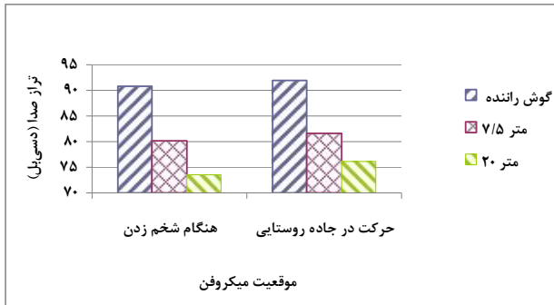
شکل (۱): تراز فشار صدای تراکتور برای نوع عملیات در موقعیت‌های مختلف میکروفن
