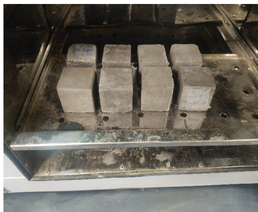
شکل 2- تست مقاومت فشاری نمونه‌های ساخته شده و قرارگیری آن‌ها در آون و قرارگیری در سیکل تنش حرارتی
