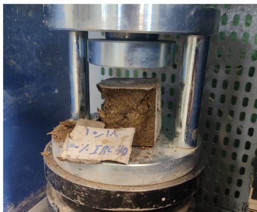
شکل 2- تست مقاومت فشاری نمونه‌های ساخته شده و قرارگیری آن‌ها در آون و قرارگیری در سیکل تنش حرارتی
