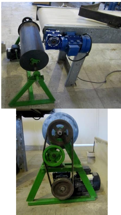
شکل ۱- اجزای مکانیکی تشکیل دهنده سامانه جداسازی شامل تسمه نقاله، استوانه دوار همراه با سیستم انتقال توان هر یک (الکتروموتور و جعبه دنده)
