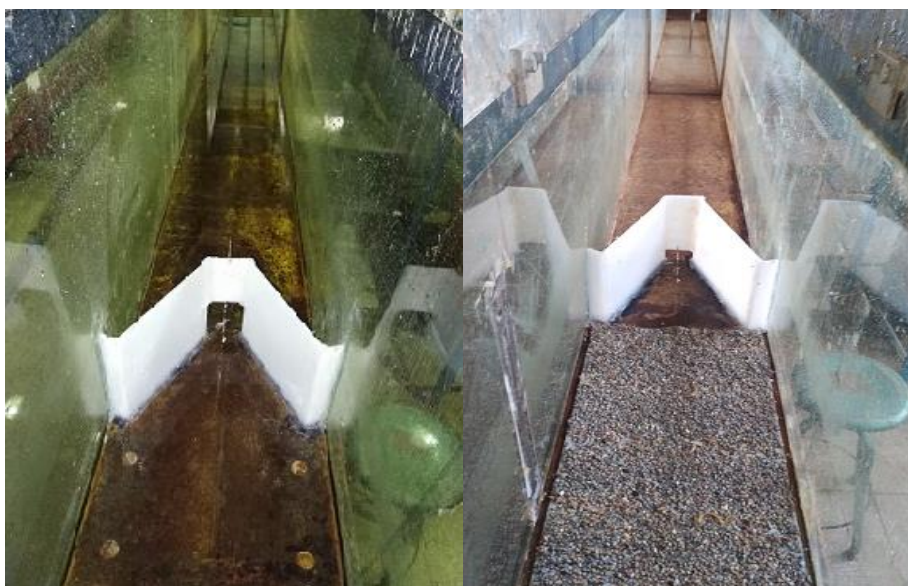
شکل ۲- مدل سرریز کنگره‌ای دوزنقه‌ای تک سیکل با وجود دریاچه در دو حالت بستر صاف و زبر.
