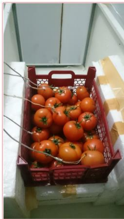
شکل ۲- گوجه‌فرنگی‌های مجهز شده به ترموکوپل در حین پیش‌سرمایش
