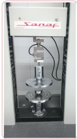
شکل ۳- دستگاه آزمون یونیورسال Fig. 3- Universal testing machine
