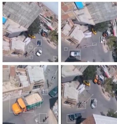
شکل ۵- تصاویری از یک فیلم ضبط شده توسط ربات پرنده چهارملخه و تشخیص اشیاء متحرک در آن توسط الگوریتم پیشنهادی به طور آنلاین
