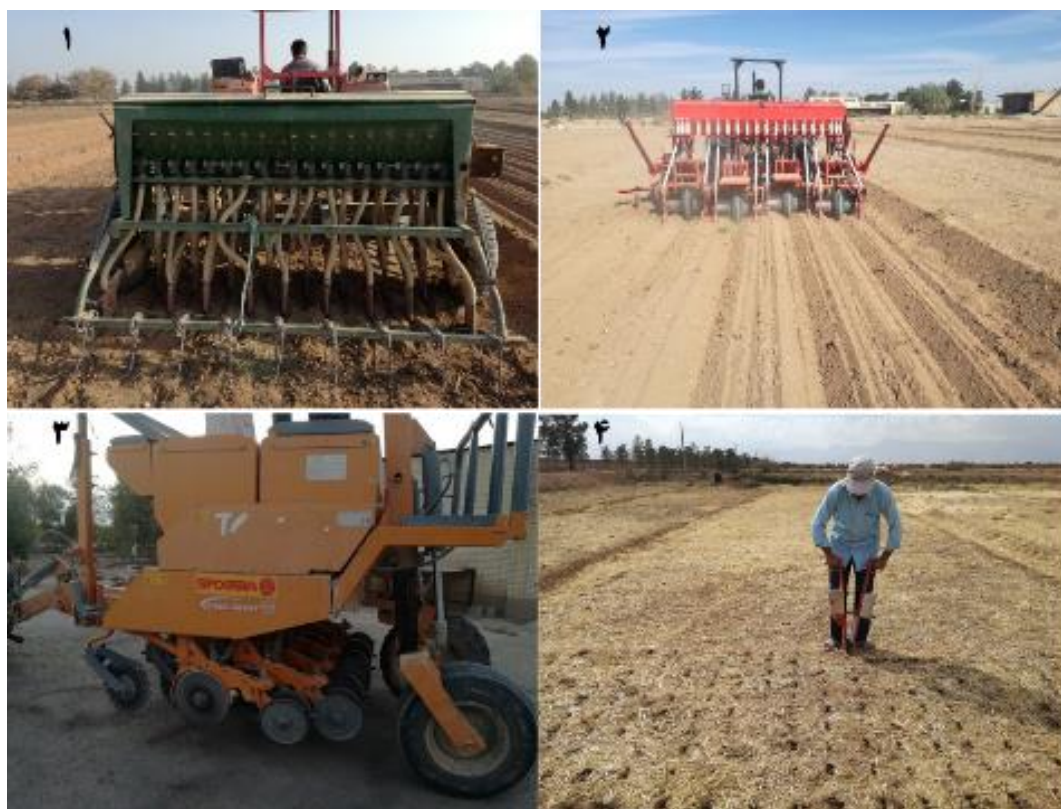
شکل ۱- ادوات مورد استفاده برای خاکورزی مرسوم به عنوان شاهد (۱)، کاشت بر روی بسترهای بلند دائمی (۲)، بی‌خاکورزی با دستگاه SFOGGIA (۳) و بی‌خاکورزی با دستگاه Jab Planter (۴)
