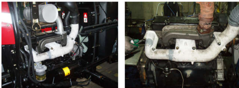
شکل ۱۷- مونتاژ منیفولد پرینت شده بر روی موتور در سلول تست (راست) مونتاژ منیفولد پرینت شده بر روی محصول نهایی، تراکتور ۴۷۵ (سمت چپ)
