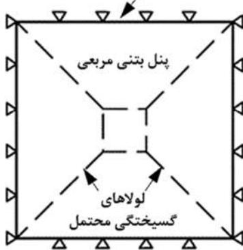
شکل ۱- لولاهای گسیختگی محتمل در یک پنل بتنی [۵].
