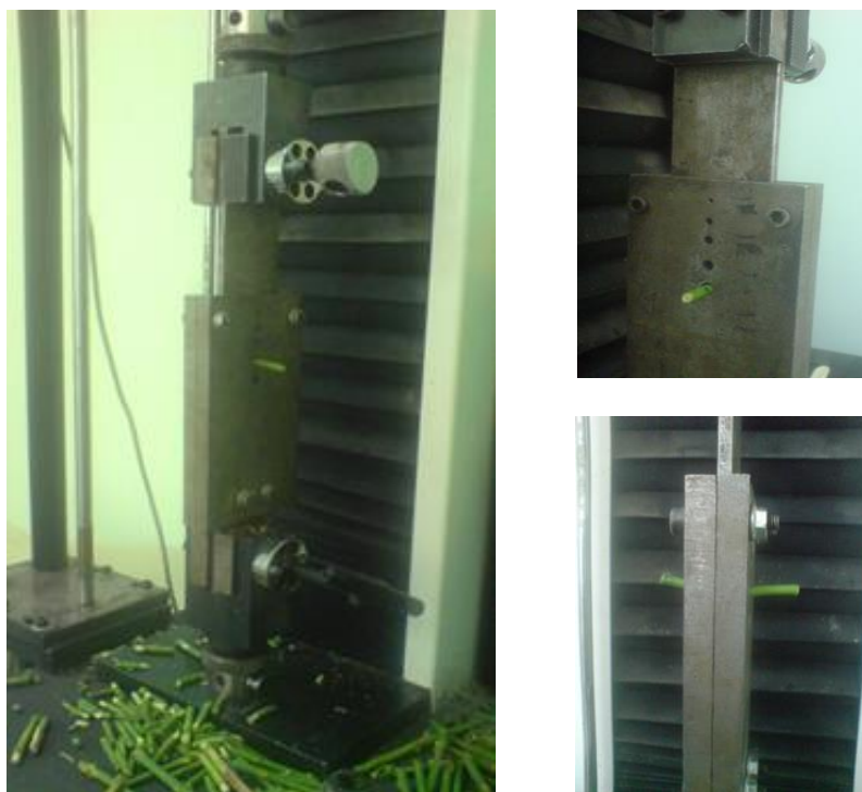
شکل ۳- دستگاه آزمون کشش- فشار یونیورسال ستنام به انضمام جعبه برش مضاعف Fig 3. Universal tension-compression test device with double-cutting box
