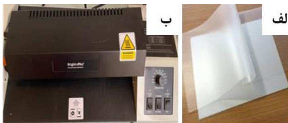
شکل ۲: الف) ورق لایه‌بندی استفاده شده در این تحقیق. ب) دستگاه لایه‌بندی کننده استفاده شده برای لایه‌بندی کردن زیربنای کاغذی.
