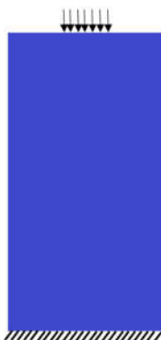
شکل ۳- تیر یکسرگیردار تحت بار توزیع شده یکنواخت اعمالی
