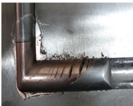
شکل ۶- تصویر کامپوزیت مس-آهن-۱ درصد نیکل دو پاس پرس شده در داخل قالب زاویه‌دار مساوی
