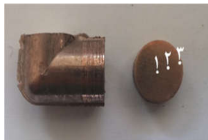
شکل ۱- نحوه برش عرضی نمونه‌های پرس شده در کانال زاویه‌دار مساوی و الگوی نقاط سختی سنجی
