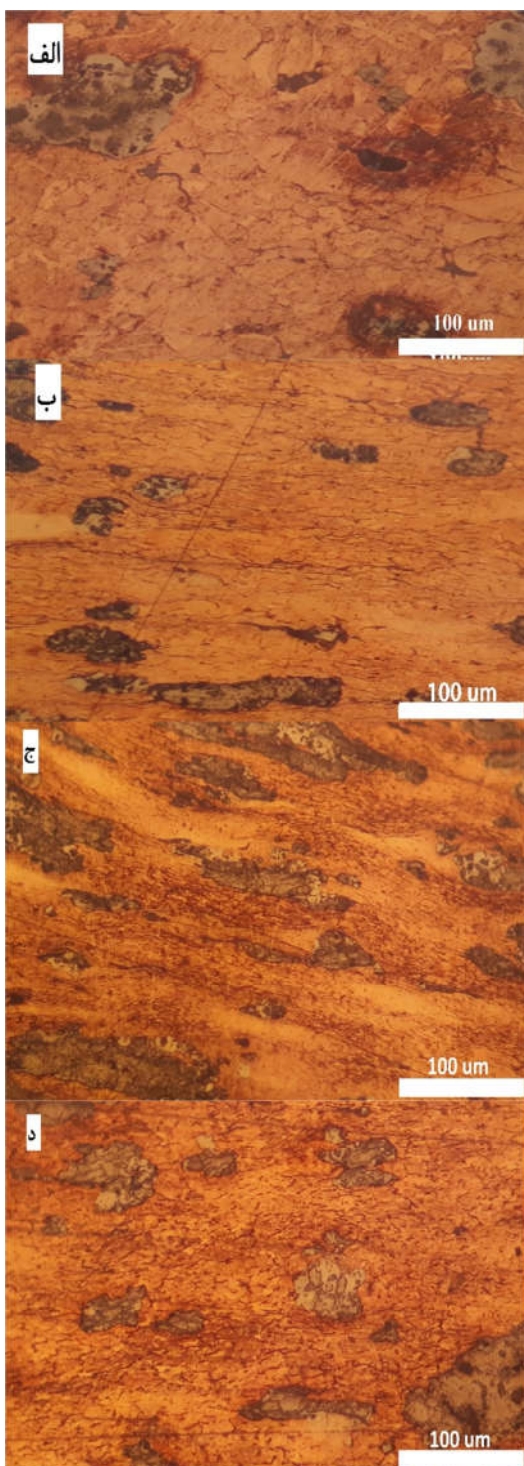
شکل ۸- تصویر میکروسکوپ نوری از کامپوزیت مس-آهن-۳ درصد نیکل پرس شده و نشده در کانال زاویه‌دار مساوی با بزرگ‌نمایی ۲۰۰ برابری:
