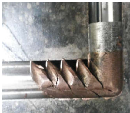
شکل ۴- تصویر کامپوزیت مس-آهن یک پاس پرس شده در داخل قالب با کانال زاویه‌دار مساوی
