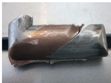
شکل ۷- تصویر کامپوزیت مس-آهن ۳ درصد نیکل پس از سه پاس پرس در کانال زاویه‌دار مساوی
