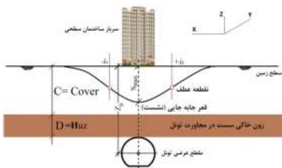
شکل ۳- نمایش همزمان هندسه تونل، زون خاکی سست (ناپایدار)، منحنی نشست سطح زمین و سربار ساختمانی.
