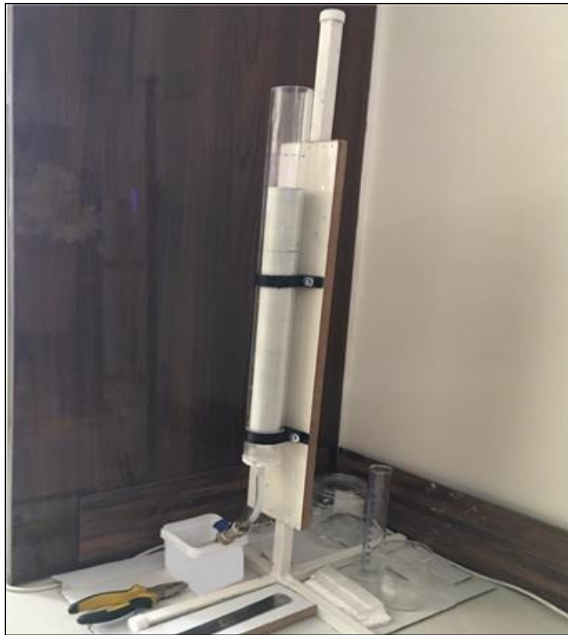
شکل ۵ تصویر شماتیک انجام آزمایش ستون و ستون ساخته شده در این تحقیق. Figure 5 Schematic image of the column test and column made in this research.
