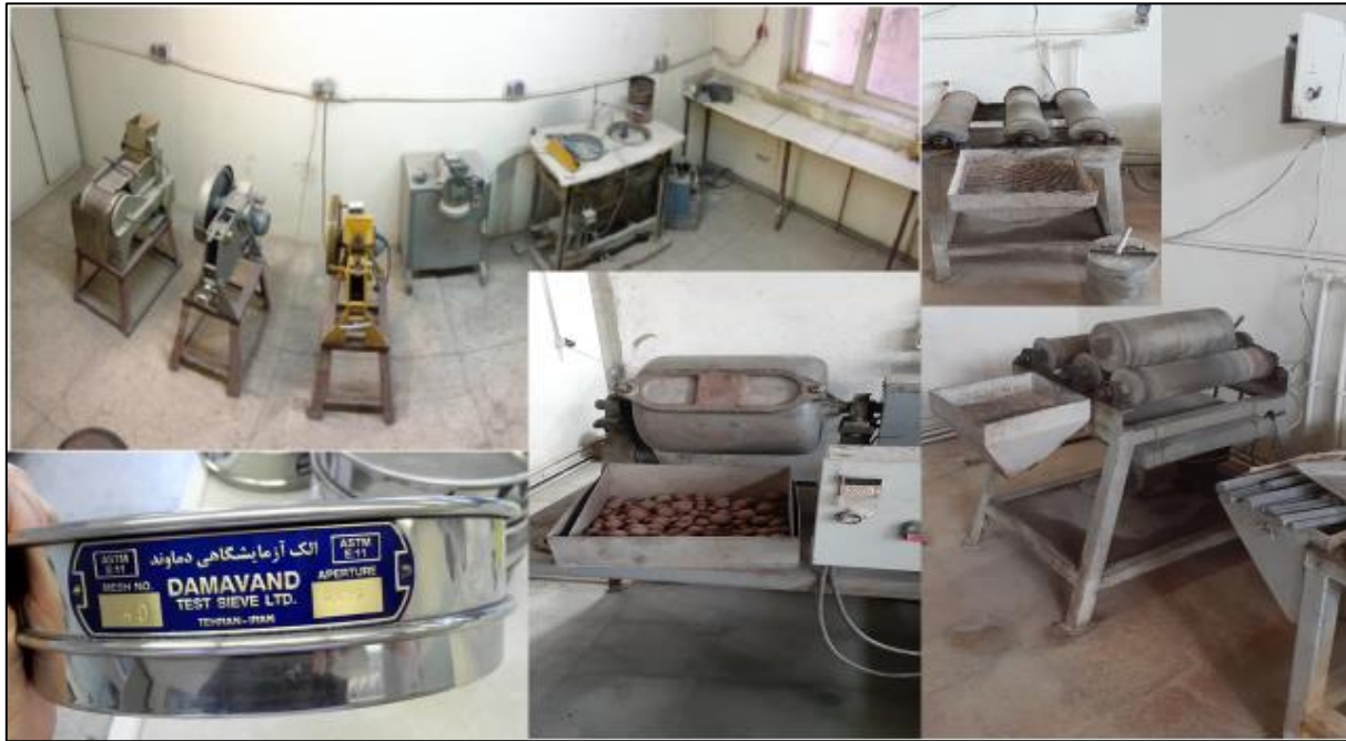
شکل ۳- انواع دستگاه‌های خردایش (آسیاب میله‌ای، آسیاب گلوله‌ای و سنگ‌شکن) و الک‌های آزمایشگاهی. Figure 3- Types of crushing devices (rod crusher, ball crusher and stone crusher) and laboratory sieves.
