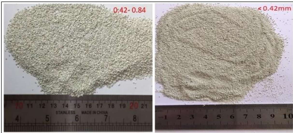
شکل ۴- ذرات زئولیت با اندازه‌های ۰/۸۴ - ۰/۴۲ میلی‌متر و اندازه کوچکتر از ۰/۴۲ میلی‌متر. Figure 4- Zeolite particles with sizes of 0.42-0.84 mm and smaller than 0.42 mm
