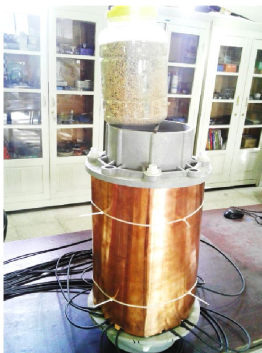
شکل ۱- طرحواره عملکرد ECT (سمت راست) و حسگر ساخته شده برای ارزیابی آزمایشگاهی (سمت چپ)
