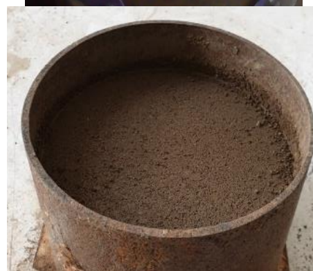
شکل ۲- دستگاه در حال بارگذاری و بعد از اعمال بارگذاری در آزمایش نشست صفحه‌ای
