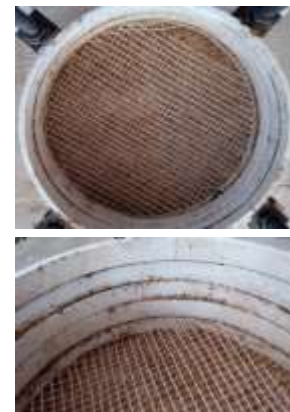
شکل ۵- نمونه گسیخته شده مسلح‌کننده ژئوگرید پس از آزمایش بارگذاری در سلول واحد
