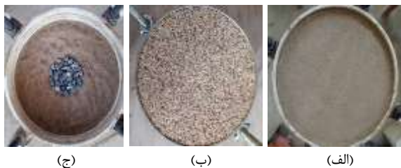
شکل ۴- الف) بستر ماسه‌ای آماده تست، ب) بستر ماسه‌ای و بالشتک دانه‌ای فوقانی، ج) بستر ماسه‌ای دارای ستون سنگی
