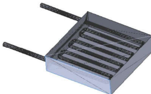
شکل ۲- مبادله‌کن گرمایی در نظر گرفته شده برای هر واحد سلول خورشیدی متمرکز [۱۸]
