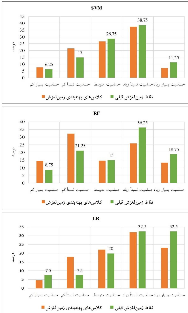
شکل (۴): مقایسه نتایج پهنه‌بندی با زمین لغزش‌های موجود Fig (4): Comparison of zoning results with existing landslides
