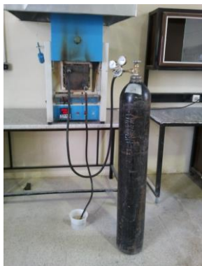
شکل ۱- پیرولیز ماده خام ساقه کلزا در کوره تحت گاز بی‌اثر نیتروژن.
