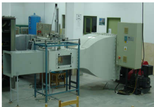
شکل ۲- تصویر تونل باد مدارباز مورد استفاده
