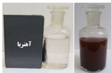
شکل ۴- تست مغناطیسی بودن نانوذرات با آهنربا
