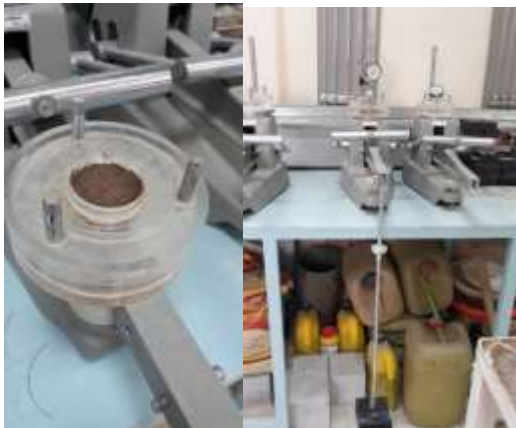
شکل ۴- نحوه ساخت نمونه و دستگاه تحکیم در آزمایشگاه
