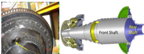
شکل ۱- ناحیه شکستگی پیچ در محل اتصال میانی دو شفت جلو و پشت و مدل برش خورده دو شفت
