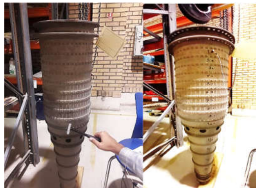
شکل ۲- نقاط قرارگیری حسگر شتاب‌سنج و وارد نمودن ضربه به شفت جلو
