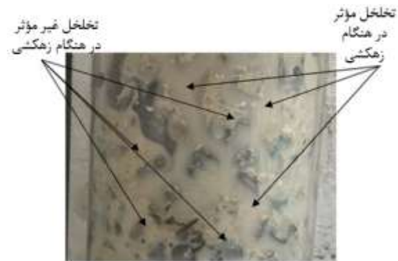
شکل ۵- تخلخل مؤثر و غیرمؤثر در ستون زهکش پر شده با ماسه
