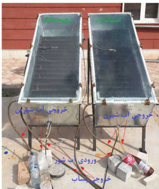
شکل ۵- دستگاه‌های آب شیرین کن شیب دار استاندارد و بهبودیافته در حال آزمایش
