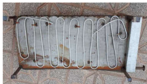
شکل ۴- عکس مبادله‌کن گرمایی که بر روی صفحه بالایی محفظه چگالنده نصب شده است.
