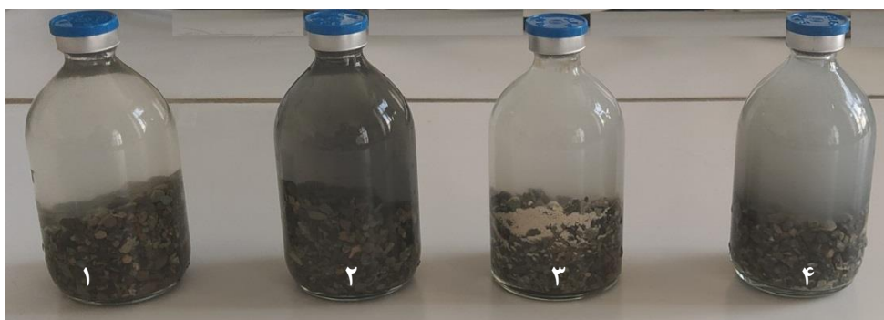
شکل ۱- شمایی از ویال‌های تست آماده شده. ۱: ویال شاهد حاوی آب زیرزمینی؛ ۲: ویال حاوی میکروذرات کربن فعال؛ ۳: ویال حاوی نانوذرات پراکسید کلسیم؛ ۴: ویال حاوی میکروذرات کربن فعال و نانوذرات پراکسید کلسیم.
