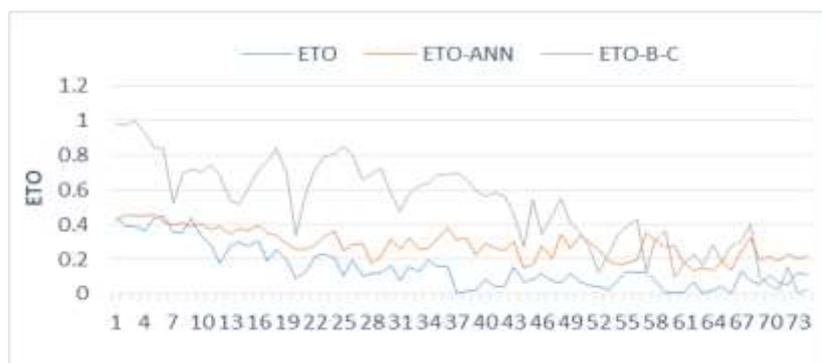
شکل ۸-مقایسه مقادیر تبخیر و تعرق اندازه گیری شده به وسیله سازمان هواشناسی منطقه (پتانسیل) با داده‌های شبیه سازی شده ANN و BC ایستگاه مراغه
