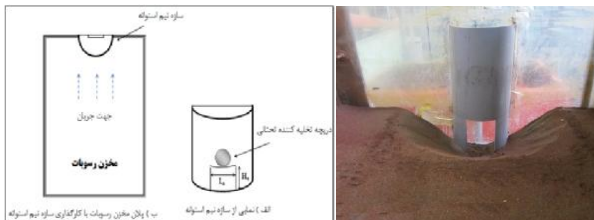
شکل 2- نمای مدل و پلان مخزن رسوبات با کارگذاری سازه نیم استوانه.
