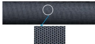
شکل ۸- مدل مش‌بندی دامنه سیال در نرم‌افزار ANSYS-FLUENT
