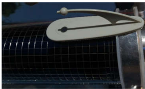
شکل ۳- نمایی از شاخص نصب شده بر روی لوله تحت خلأ به منظور ردیابی خورشید
