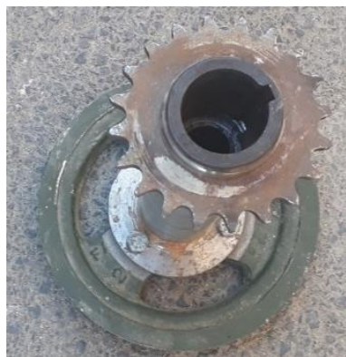
شکل ۱۳- پولی انتقال نیرو
