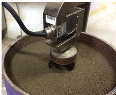
شکل ۱- نمایی از نیروسنج و صفحه بارگذاری طی آزمون نشست صفحه‌ای خاک
