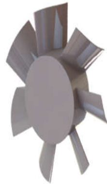
شکل ۱- فن محوری رندر شده با نرم‌افزار Solidworks
