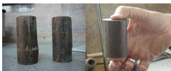
شکل ۲- (الف) نمونه آماده‌شده برای آزمایش تک‌محوری، (ب) نمونه آزمایش‌شده در دستگاه تک‌محوری
