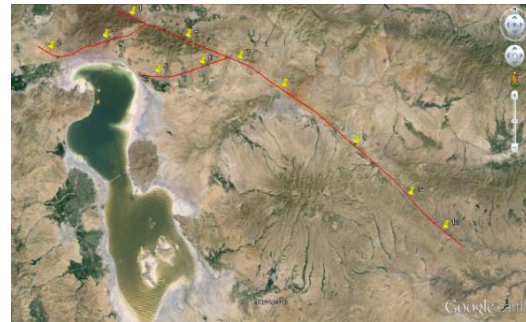
شکل ۶- شاخه‌بندی گسل شمال تبریز به نحوی که هر بخش دارای امتداد و شیب تقریباً ثابتی است.
