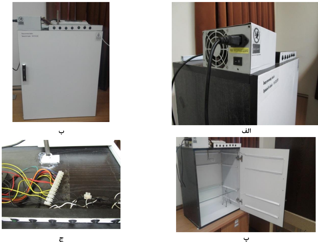
شکل ۱- محفظه تصویربرداری (الف) منبع تغذیه، (ب) محل تعبیه کلیدهای کنترل، (پ) فضای داخلی و محل تعبیه LED، (ج) پورت های ولتاژ و آمپر متفاوت
