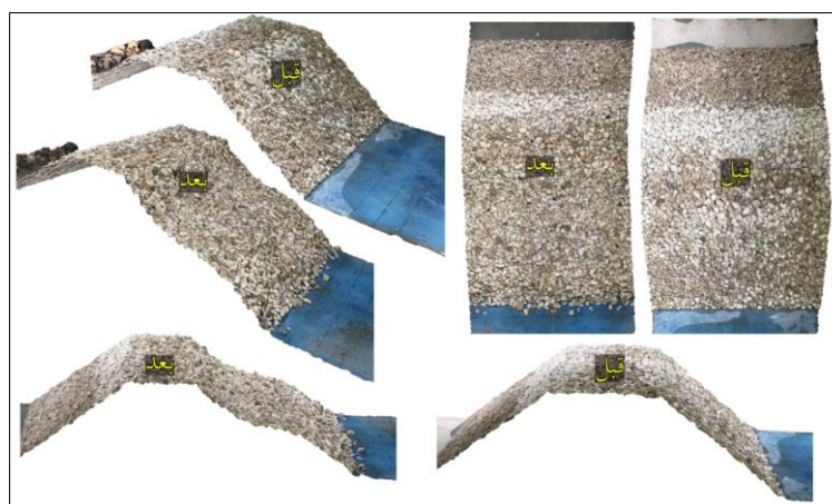
شکل ۹- نمایشی از پلان، ایزومتریک و مقطع موج‌شکن شکل‌پذیر بدون مانع قبل و بعد از انجام آزمایش
