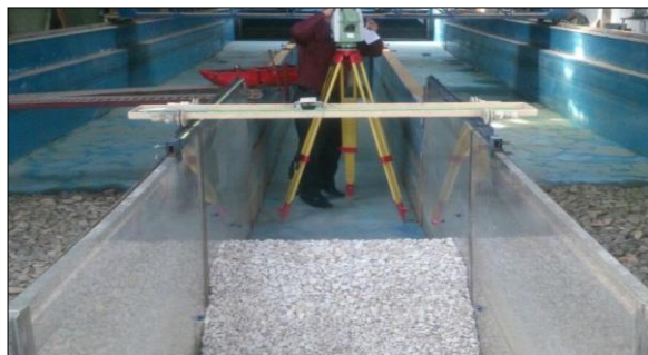
شکل ۵- نقشه برداری نقاط پایه و جانمایی مارکرها
