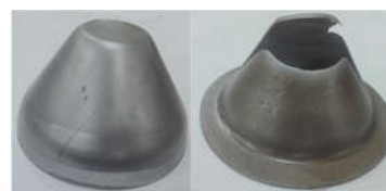
شکل ۱۱- الف- پارگی ایجاد شده در فشار ۴ MPa ب- قطعه شکل داده شده در فشار ۱۲ MPa
