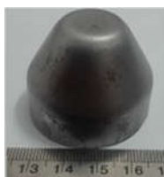
شکل ۱۵- قطعه c تولید شده با روش هیدروفرمینگ
