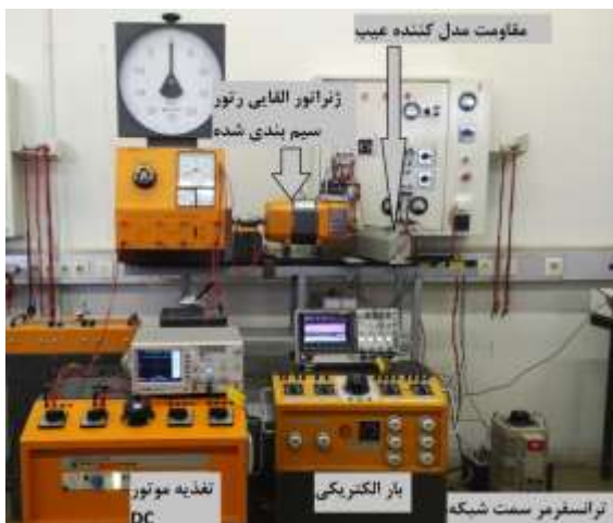
شکل ۱۴- تصویر سیستم تست شده.
