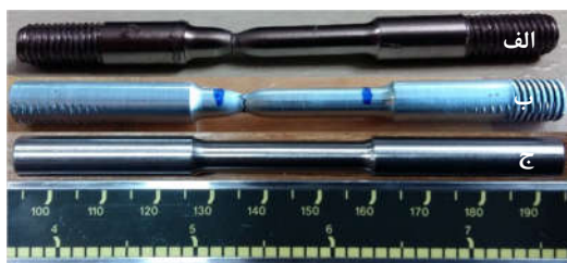
شکل ۱- (الف) نمونه‌های تست پس از انجام آزمایش تحت دمای بالا، (ب) دمای معمولی، و (ج) نمونه تست قبل از انجام آزمایش
