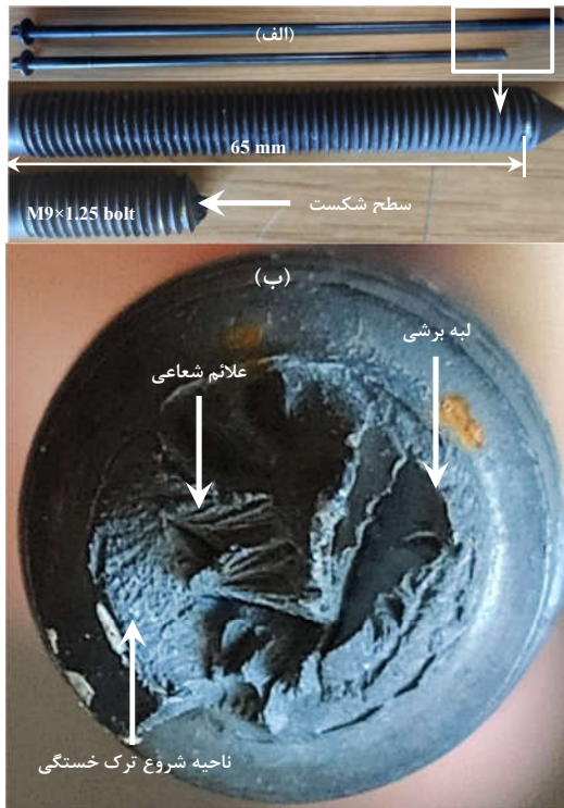
شکل ۴- (الف) مقطع طولی نمونه پیچ سالم و شکسته شده، و (ب) مقطع سطح شکست پیچ
