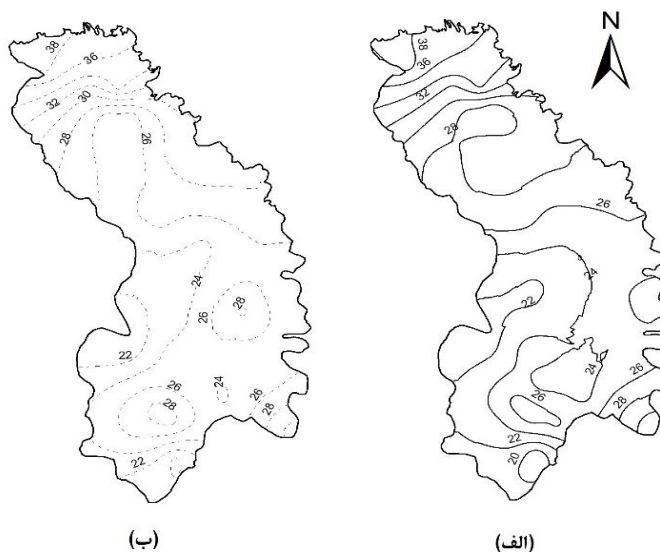
شکل ۶- وضعیت تراز سطح ایستابی آبخوان به ترتیب در شرایط (الف) قبل و (ب) بعد از توسعه شبکه آبیاری.
