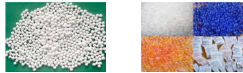
شکل ۲- انواع مواد جاذب رطوبت در نم زدایی گاز طبیعی، (الف) سیلیکاژل، (ب) آلومینای فعال [۸]
