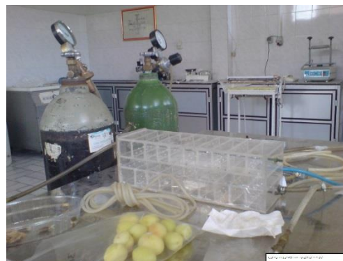
شکل ۱- تزریق گازهای مورد استفاده در بسته‌بندی با اتمسفر تغییر یافته
