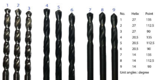
شکل ۳ - مته‌های با قطر ۳/۵ میلی متر استفاده شده در آزمایش‌ها
