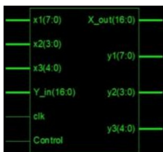
شکل ۶: بلوک دياگرام کلی مبدل ترکيبی مستقيم/معکوس
